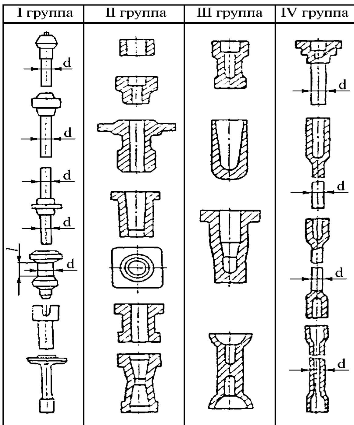
Рисунок 1 - Виды поковок, штампемых на горизонтально-ковочных машинах:
