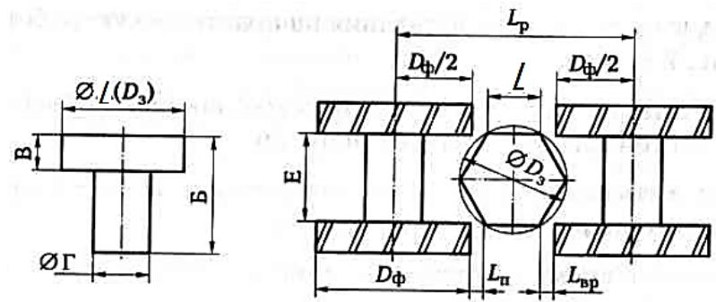
Рисунок 3.1 – Схема фрезерования в три перехода
