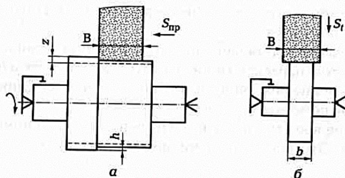
Рисунок 3.2 – Шлифование наружной цилиндрической поверхности:
