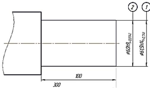
Рисунок – Эскиз детали Вал
