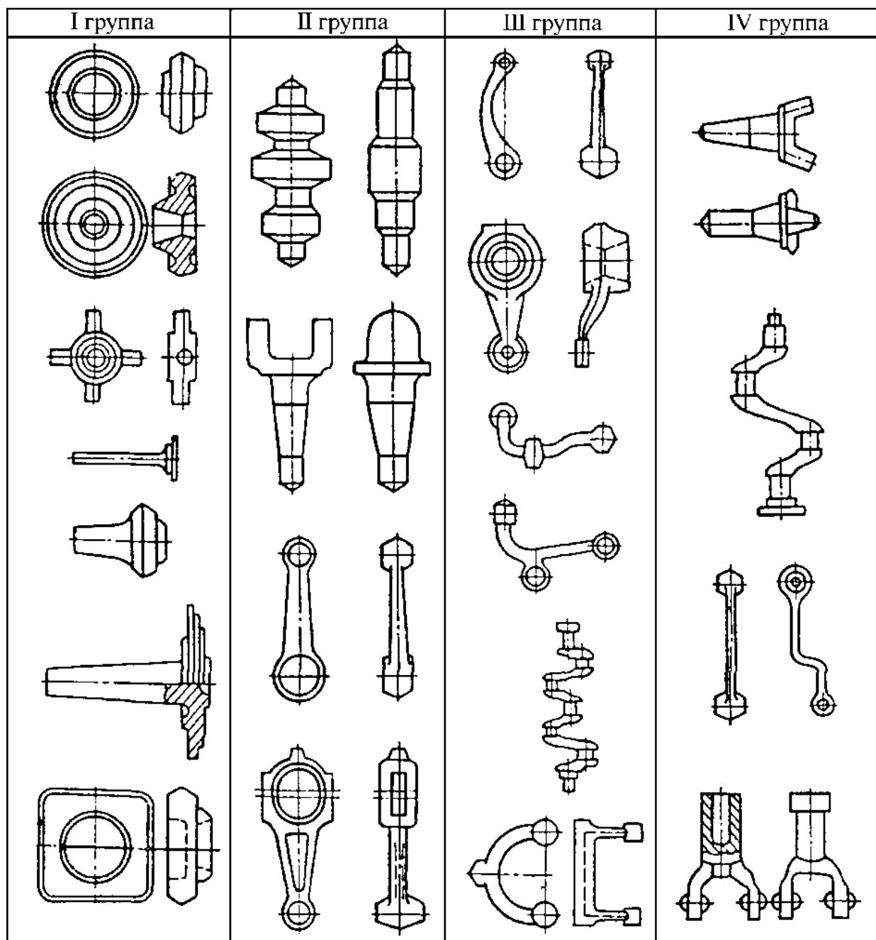
Рисунок 2 - Виды поковок, штампемых на молотах и горячештамповочных прессах:
